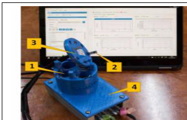
Figura 37 Platforma electrochimică de detecție realizată: (1)Recipient pentru probe, (2) dispozitiv de detecție, (3) capac, (4) suport imprimat 3D
