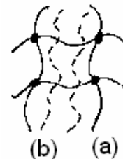
Fig. 1 Structure of SIPN: (a) PU; (b) ER
